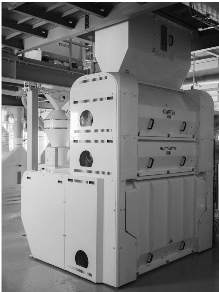
Obr. 8: Šrotovník sladu instalovaný v roce 2025, pivovar Budějovický Budvar (zdroj: Jan Luxík)
